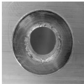
Obr.5 Orezaný nákrúžok – material Al Fig.5 Cut collar – material Al
