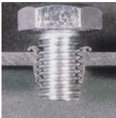
Obr.1 Detail termálneho vrtania- rozoberateľný spoj [4] Fig.1 Detail of thermal drilling-demountable joining [4]
