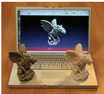
Obr.4 Príklad reálnej repliky pomocou 3D skenovania a 3D tlače
