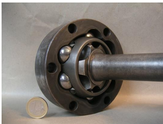
Obr. 1 Príklad najbežnejšie používanej konštrukcie homokinetického klbu
