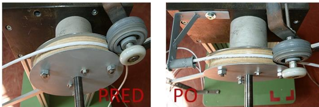
Obr. 3 Úprava rozhrania človek – technológia; aplikácia vodítka pre kábel
