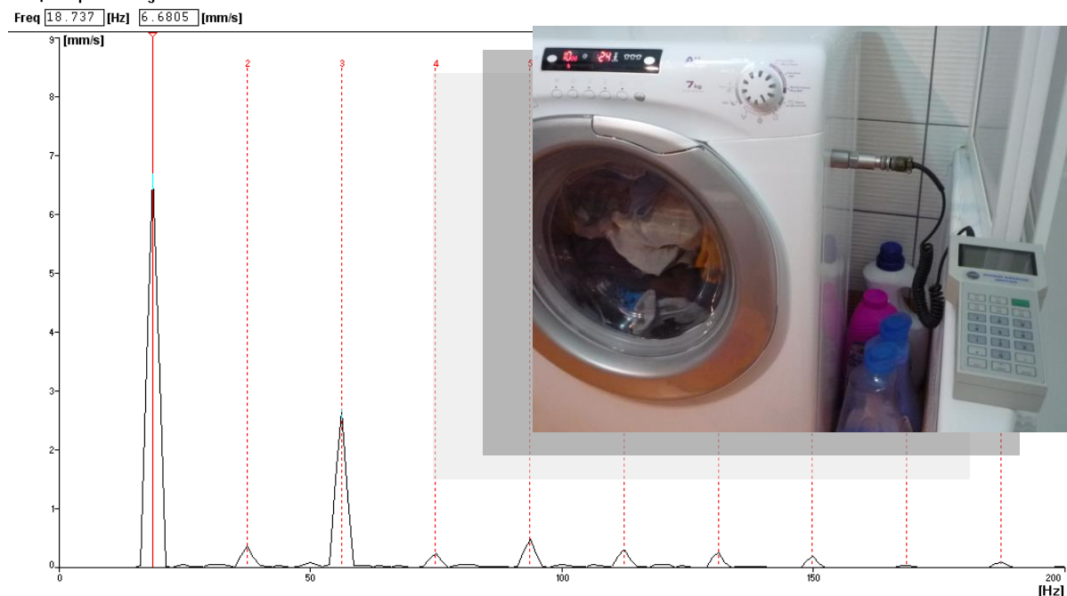
Obr. 2 Spektrum signálu pri meraní skutočných otáčok bubna práčky a umiestnenie snímača.
