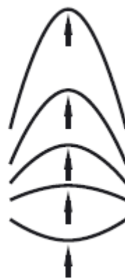
Obr.7. Poloha oblúka - statické podopieranie, tendencia vyvesenia.
