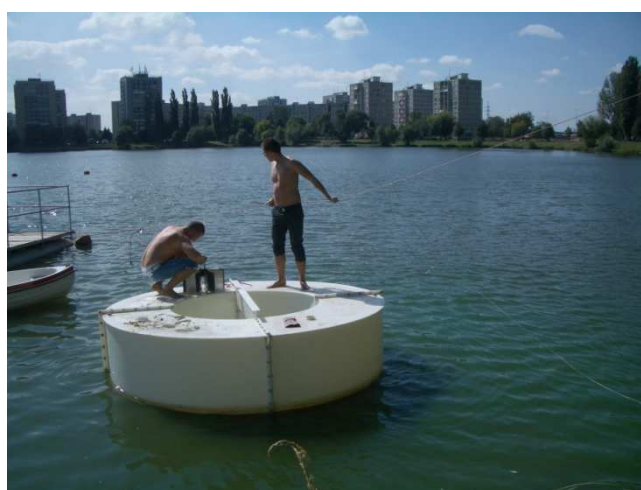
Obr. 13 Inštalácia elektród na plaváky na košíckom jazere letná sezóna 2012
