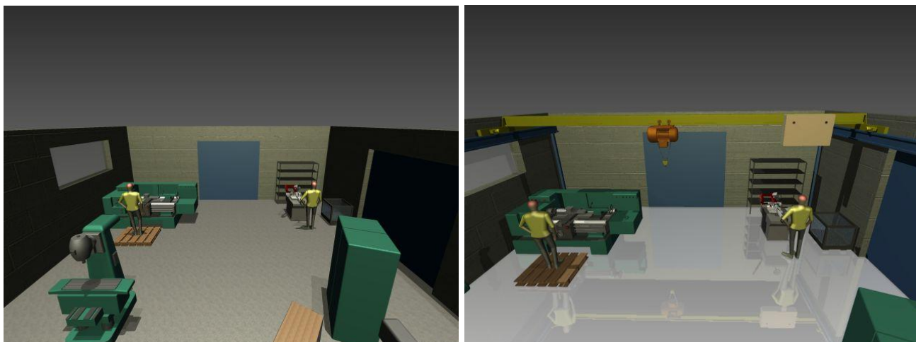
Obr. 5 Model časti haly pred a po zavedení žeriava
