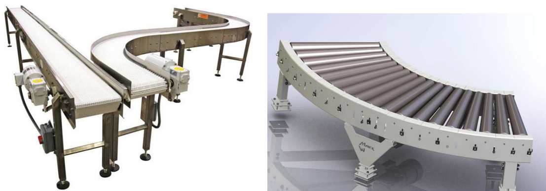
Obr.5. Príklady dopravníkových systémov
