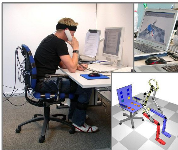
Obr. 3 Meranie stoličky v laboratórnych podmienkach podľa [3]
