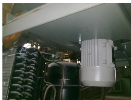
Obr. 5 Chladiaci systém a nový asynchrónny motor odstredivky
