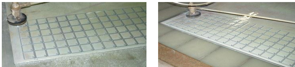
Obr. 2 Rezanie skúšobných vzoriek
