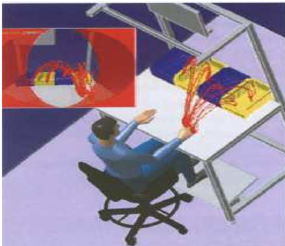
Obr.6 Príklad 3D modelu pracoviska demontážneho systému
