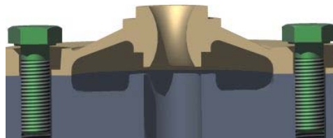
Obr.27 Príklad stredenia súčiastky
