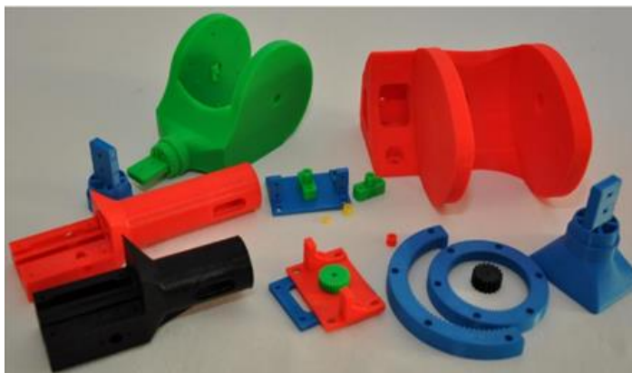
Obr. 16 Časti ramena tlačené na 3D tlačiarňi [1]
