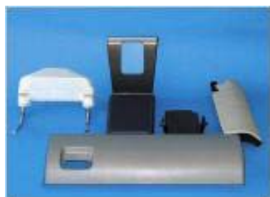
Obr. 10 Príklad kombinácie plast- kov, biely komponent [4]
