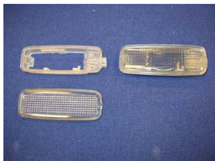
Obr.6 Kombinácia zvaru plast –plast [4]
