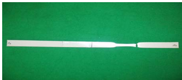
Obr. 9 Porušenie vzorky mimo zvarenej časti
