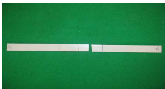
Obr. 11 Porušenie vzorky v mieste zvaru
