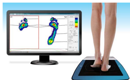
Obr. 2 Systém pre analýzu rozloženia tlaku pod chodidlom počas chôdze a stoja (Sensor Products).
