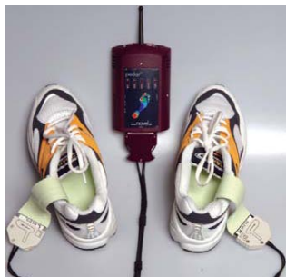
Obr. 3 Systém MTS snímajúci tlak priamo v obuvi (Novel)
