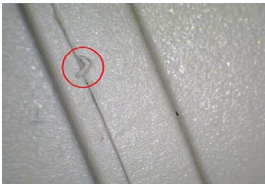
Obr.11 Spálenina na povrchu výrobku
