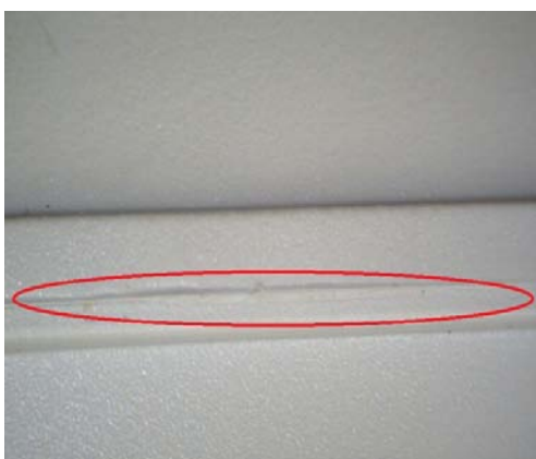
Obr.7 Vytečený zvarový spoj na povrchu výrobku
