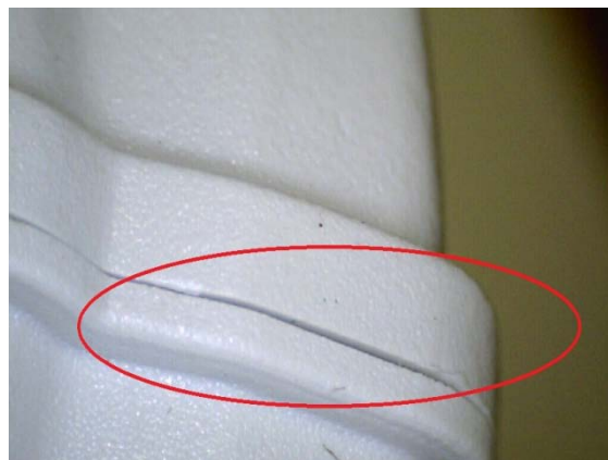
Obr.10 Nezvárená časť spoja na zaoblenej ploche výrobku
