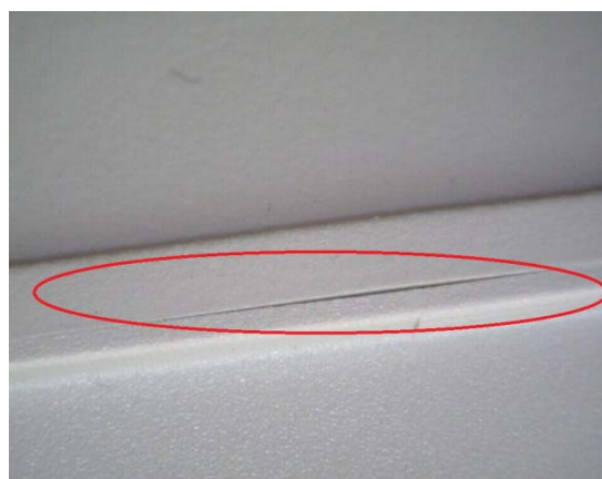
Obr. 9 Nezvárená časť spoja na rovnej ploche výrobku
