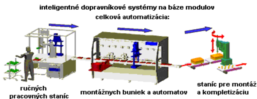
Obr. 1 Automatizácia montážnych systémov prostredníctvom modulových dopravníkových riešení
