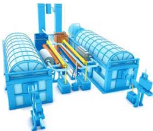
Obr.4 Linka na spracovanie pneumatík pyrolýzou.
