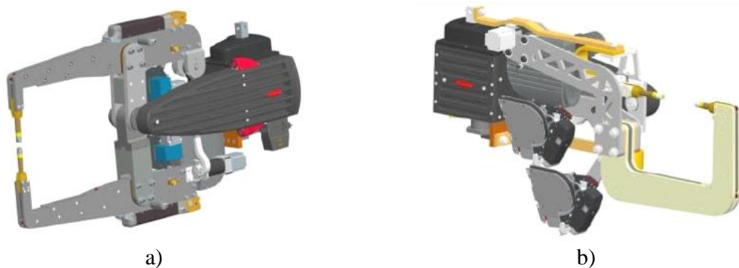
Obr. 24 Kliešte pre deltapot zváranie a – kliešte typu X, b – kliešte typu C
