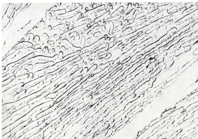
Obr. 4.6 Perlitická štruktúra pozorovaná pomocou dvojstupňovej pozitívnej repliky
