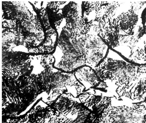
Obr.2.4 Mikroštruktúra perliticko feritickej sivej liatiny, zv. 100 x
