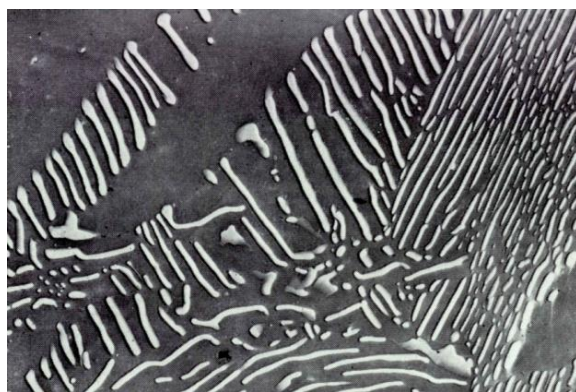
Obr. 4.4 Perlitická štruktúra pozorovaná pomocou jednostupňovej negatívnej repliky (svetlé lamely cementitu a hladké tmavé plochy feritu)
