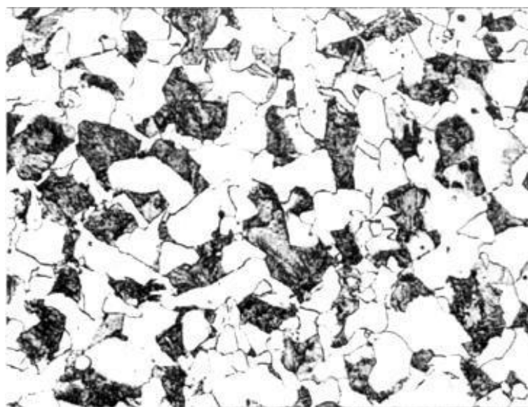
Obr. 6.2 Mikroštruktúra feriticko-perlitickej ocele, zv. 310x
