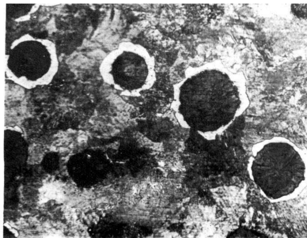
Obr.2.7 Mikroštruktúra tvárnej perlitickej liatiny, zv. 400 x
