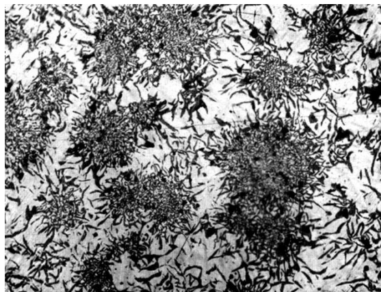
Obr.2.9 Mikroštruktúra pavúčkovitého grafitu v neleptanom stave. Zv 100 x
