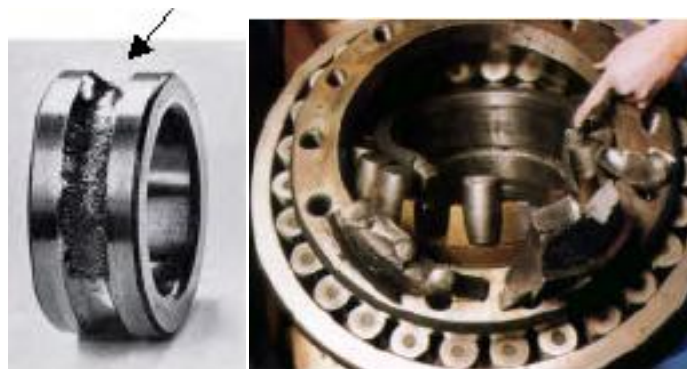
Obr. Ukážka tvorby pitingov a porúch na ložisku
