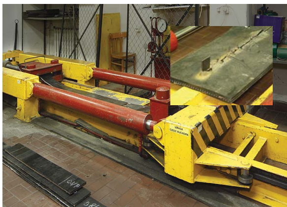
Figure 3 Horizontal ZT 40 tensile testing machine and longitudinal cutting of ST3150 14T+7T belt slika 3 Horizontalna mašina za ispitivanje rastezljivosti ZT 40 i sečenje po dužini trake ST3150 14T+7T
