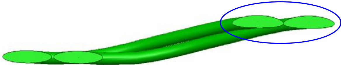
Obr. 5 Rez modelov susedných drôtov s medzerou \Delta = 0,050 \text{ mm}
