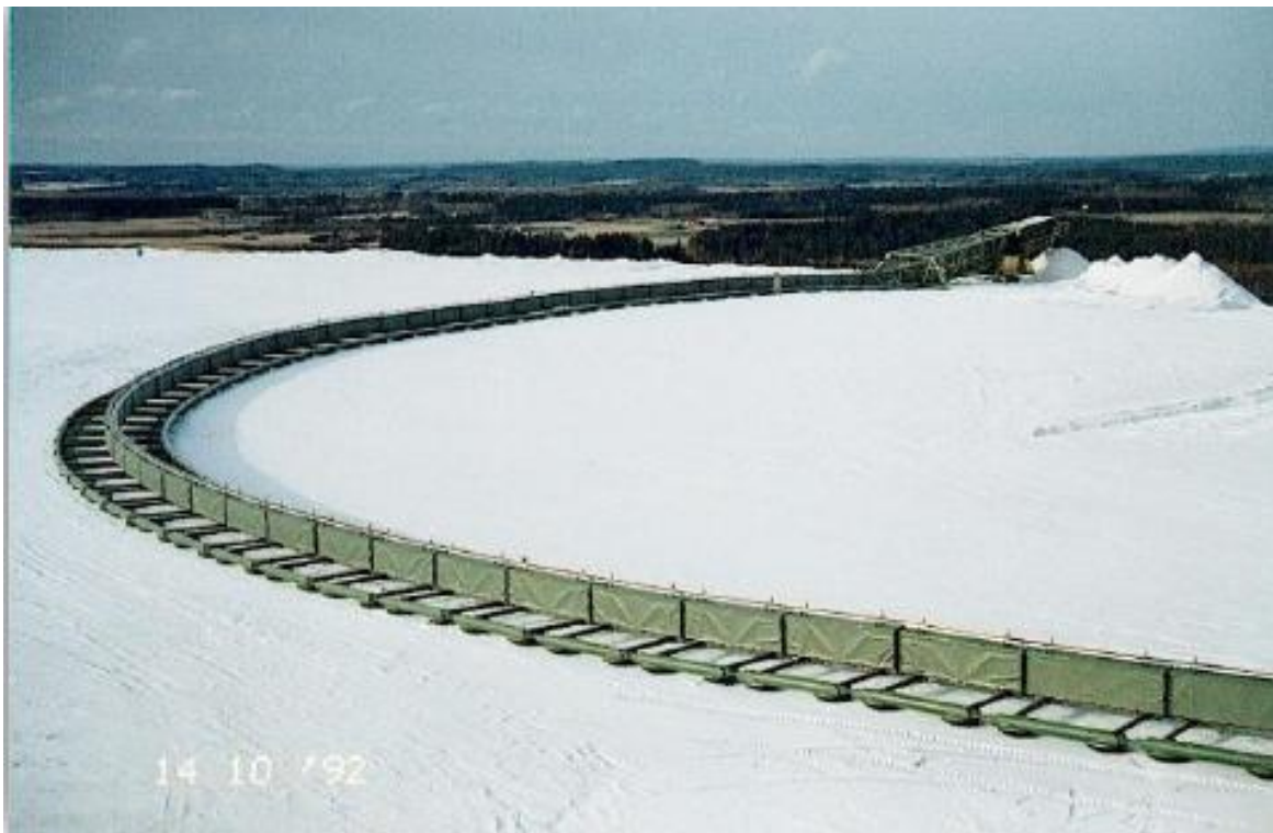
Obr. 2 Trať hadicové dopravníka vo Fínsku [1]
