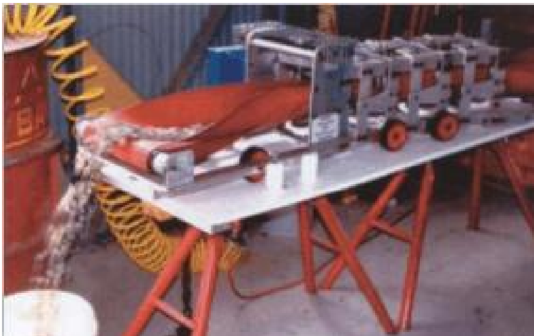
Obr. 4 Variabilný hadicový dopravník Bosmin [2]
