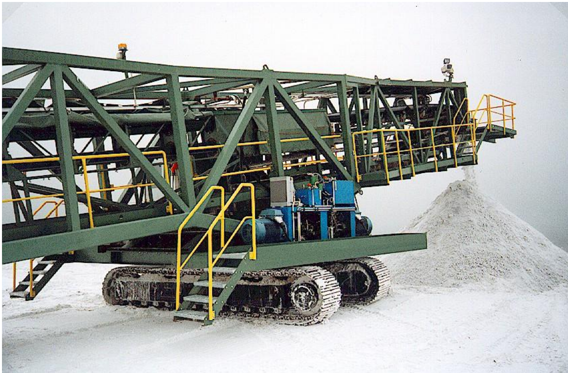
Obr. 1 Výsypná časť hadicové dopravníka [1]
