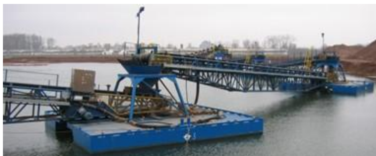
Obr. 1 Plovoucí pásová dopravní trasa s koncovými plováky
