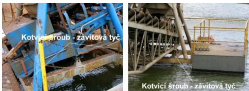
Obr. 6 Kotevní šrouby mechanicky spojující pásový dopravník s plovoucím členem
