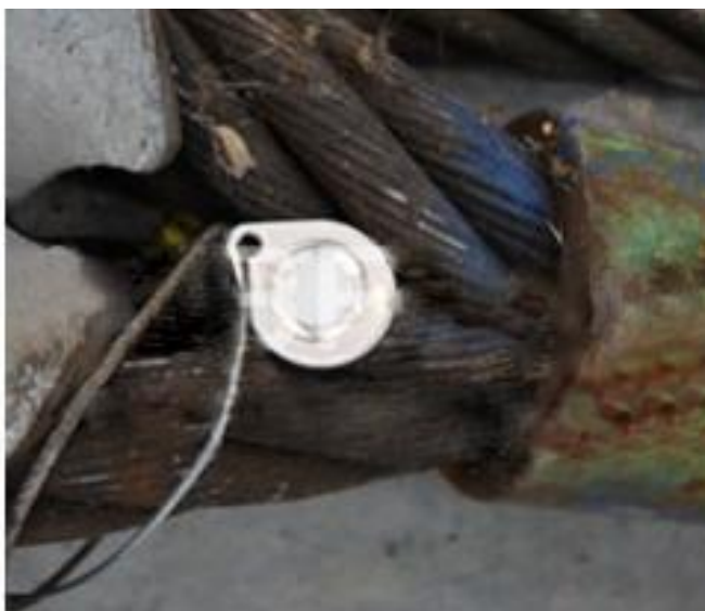
Obr. 6 RFID tag pripevnený na ocel'ových lanách [5]
