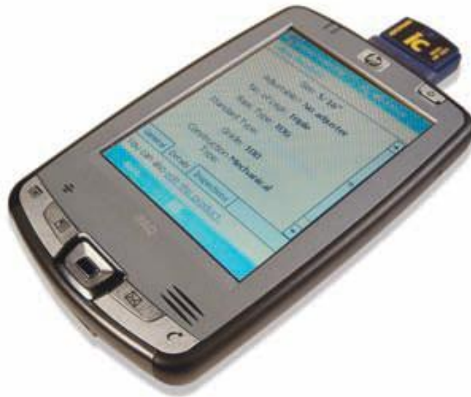
Obr. 8 Mobilné zariadenie na snímanie RFID tagov a editáciu revíznych dát [7]
