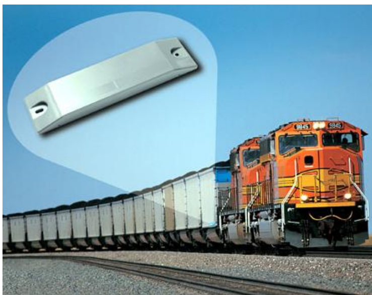
Obr. 4 RFID tag pripevnený na vagóne vlakovkej súpravy
