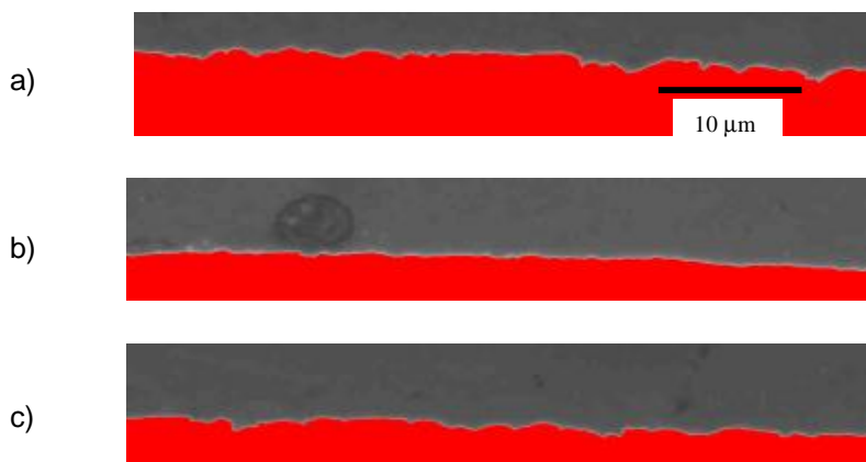
Obr. 4 Časť povrchu naťahného drôtu priemeru \varnothing 2,10 mm (a – z cievky č. 1; b – z cievky č. 9; c – z cievky č. 25). Zväčšenie 1000 krát.
