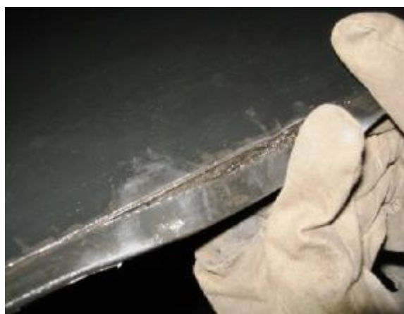
Rys. 3 Uszkodzenie brzegu taśmy odstaniające linki stalowe
