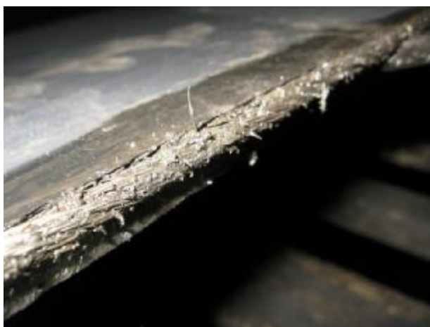
Rys. 4 Odstłonięta linka stalowa umieszczona na brzegu taśmy Rys. 5 Wyrwany brzeg taśmy przenośnika taśmy
