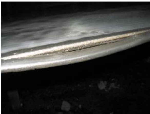
Rys. 3 Uszkodzenie brzegu taśmy odstaniające linki stalowe
