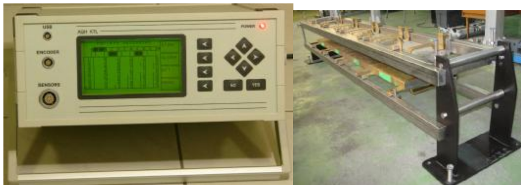
Rys. 17 System monitorowania taśm z linkami stalowymi
