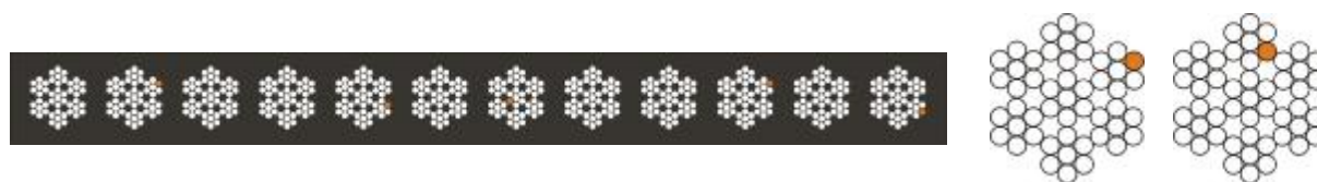
Rys. 6 Przekrój pasa z pięcioma pękniętymi drutami (Pęknięcie 5 drutów o średnicy 0,18 mm (0,85 % przekroju metalicznego)-sygnał ok. 15 mV)
