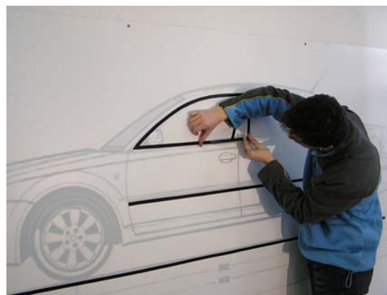
Obr.1 Tvorba páskového modelu klasickou technikou páskového modelovania
