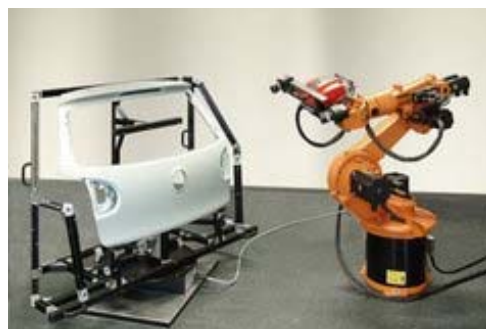
Obr.2: Využitie 3D skenera Atos v automobilovom priemysle
