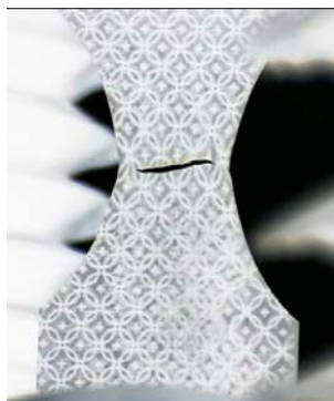
Obr. 6 Vzorka tesne po vzniku trhliny Fig. 6 Specimen after fracture
