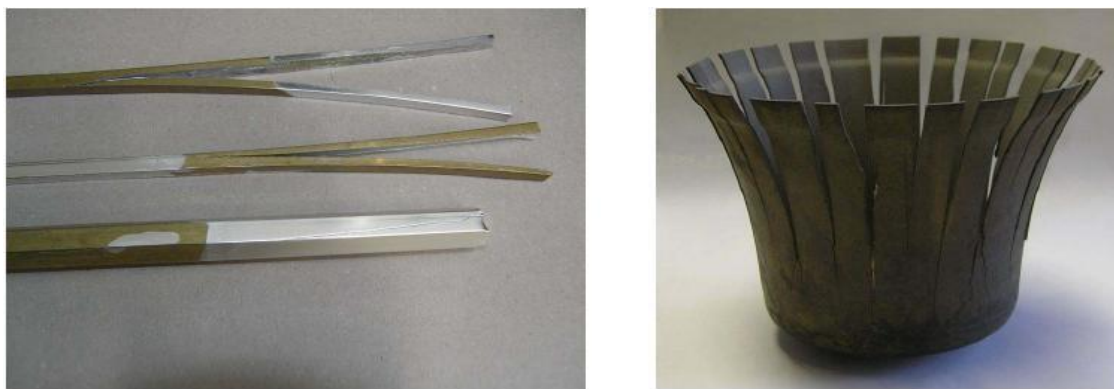
Obr. 10.6 Korózia pod napätím
