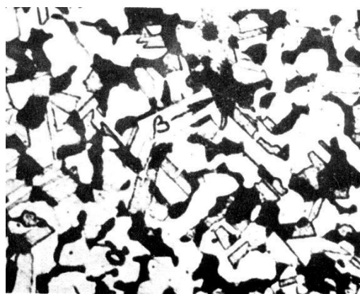
Obr.12.9 Mikroštruktúra \alpha + \beta mosadze tvárnenej a žihanej. Zv 100 x
