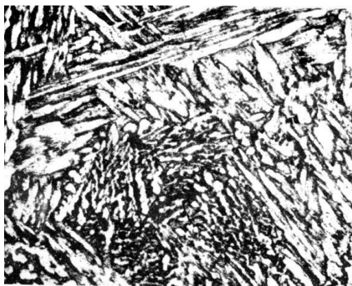
Obr.12.8 Mikroštruktúra \alpha + \beta mosadze liatej. Zv 90 x
