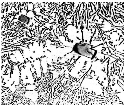
Obr.12.4 Mikroštruktúra silumínu. Si je vylúčený vo forme veľkých ihlíc, zv 200 x
