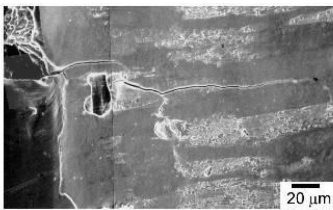
Obr. 9.5 Mikroštruktúry lamelárnej trhliny
