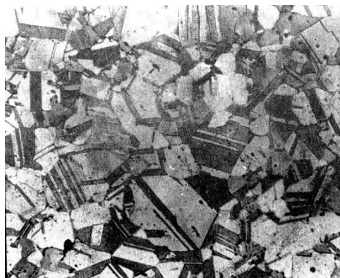
Obr.12.7 Mikroštruktúra tvárnenej medi, zv. 100 x
