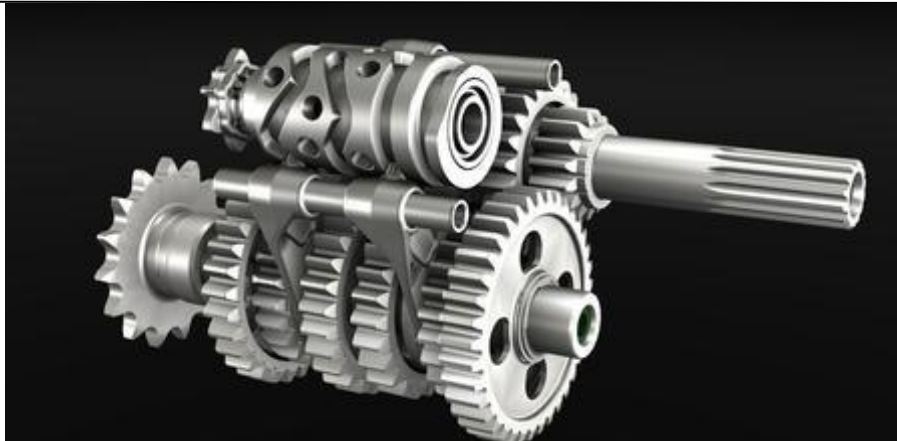
Obr. Dvojhriadeľová prevodovka s postupným radením
