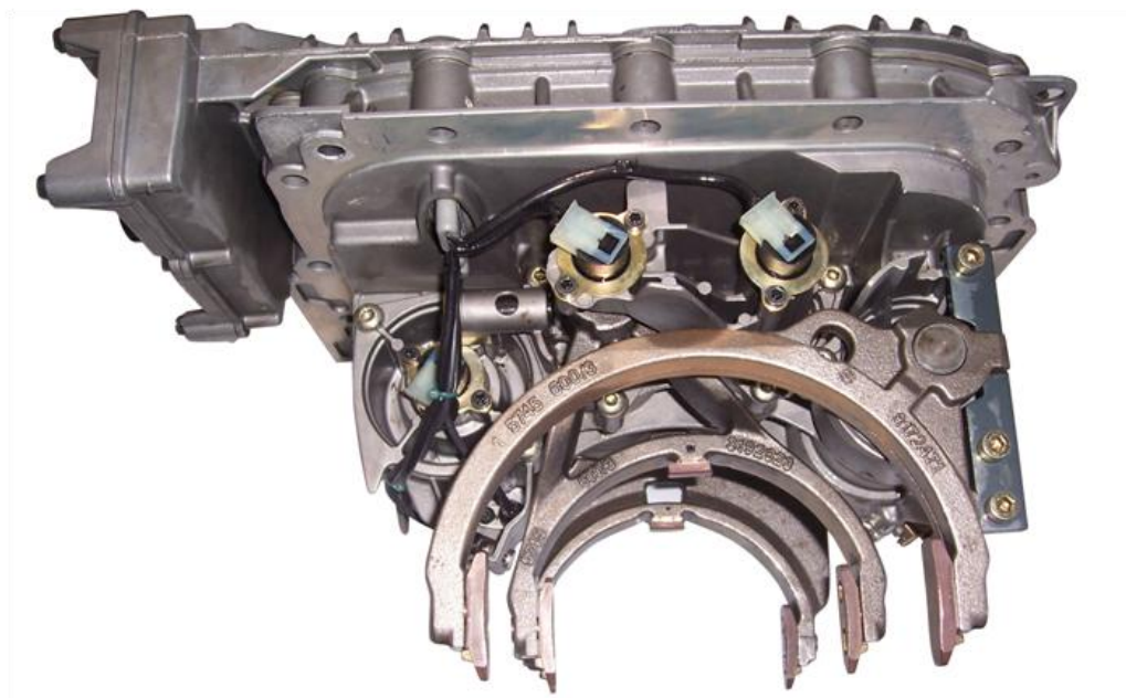
Radiaci systém robotizovanej prevodovky
