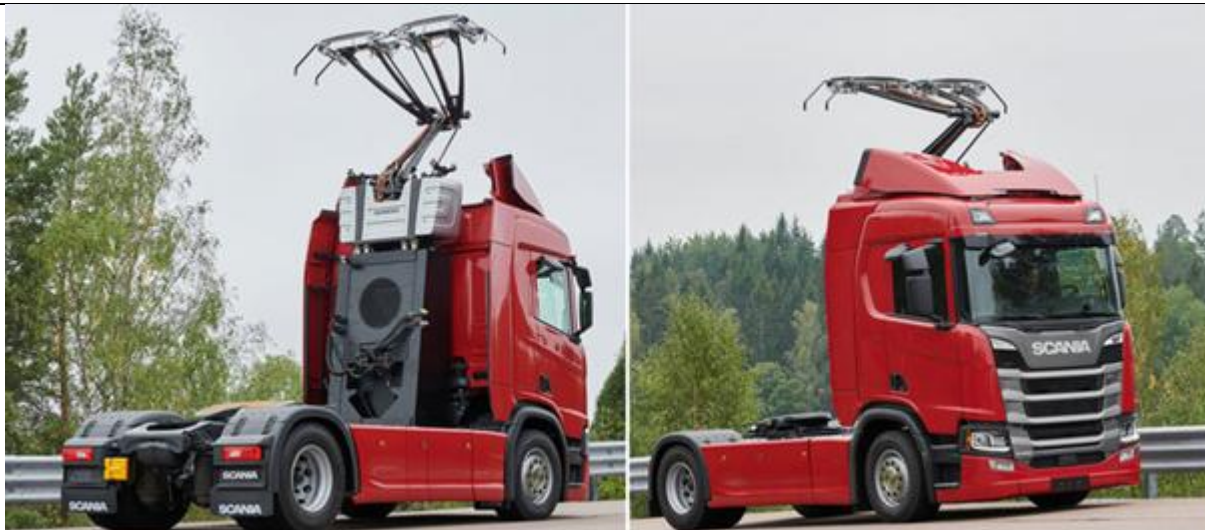
Umiestnenie trolejových zberačov na nákladných vozidlách
