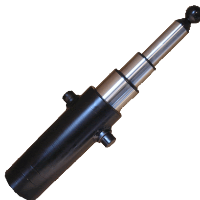
B) teleskopický jednočinný Priamočiary hydromotor
