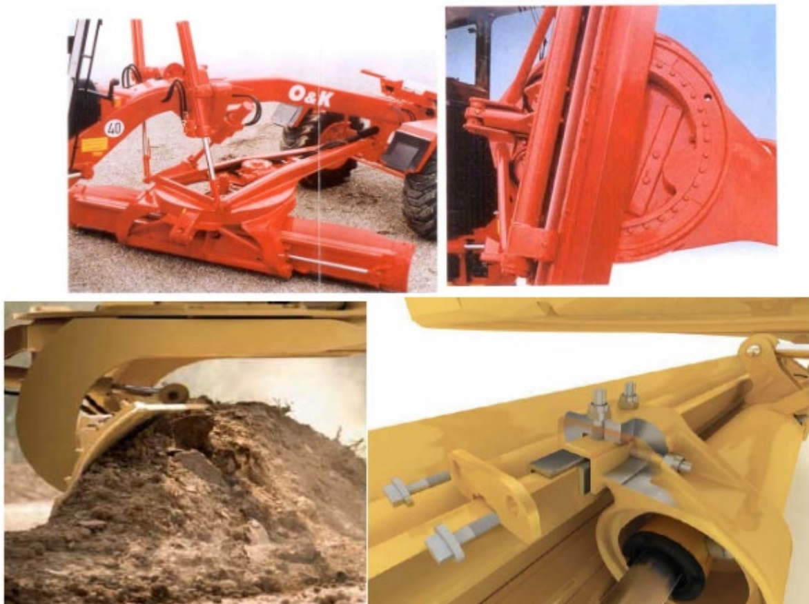
Obr. 5.50 Mechanizmus ovládania univerzálnej radlice [9]
