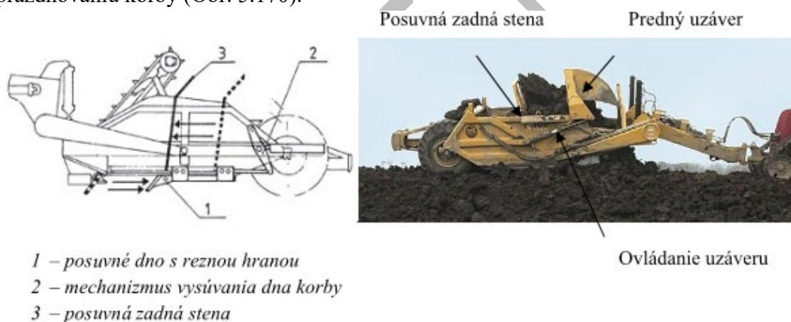
Obr. 5.170 Nútené vyprázdňovanie korby zadnou posuvnou stenou [9]
