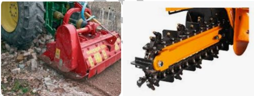
Obr. 2.8 Zariadenia zo skupiny zemných fréz [5]
