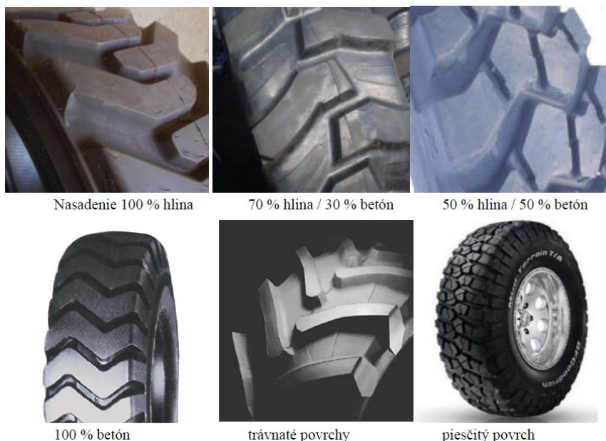
Obr. 3.20 Tvary dezénov behúnov [9]
