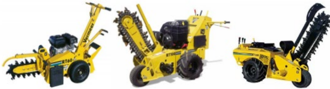
Obr. 5.193 Ručne vedené ryhovače [9]
