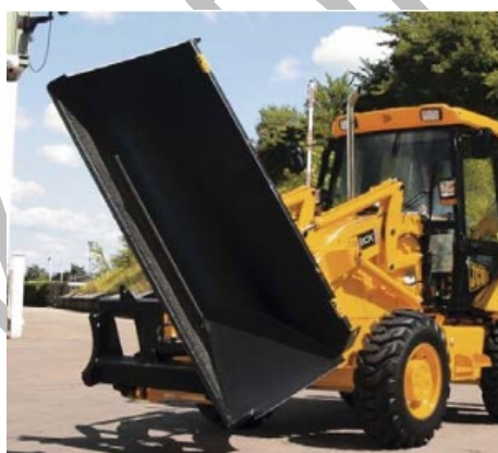
a) Lopata s bočným naklápaním
