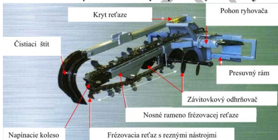
Obr. 5.185 Základné časti reťazového ryhovača [9]
