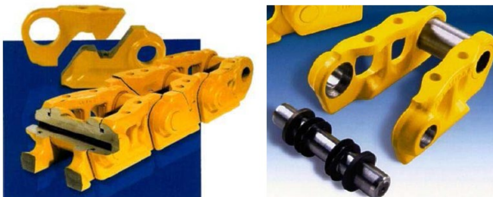
Obr. 4.46 Články reťaze rôznej veľkosti sa priradujú k strojom podľa ich hmotnosti (vľavo je spojovací článok) [4]
