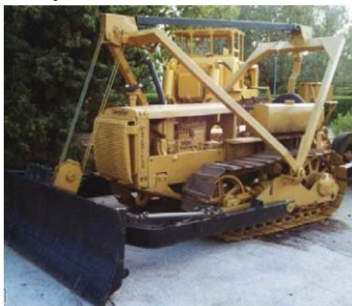
Obr. 5.12 Ovládanie radlice lanovým Prevodom [7]
