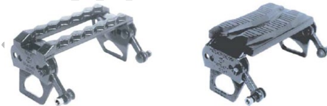
Obr. 4.63 Článok OTT pásu – celokovový (vľavo) a pogumovaný (vpravo) [4]
