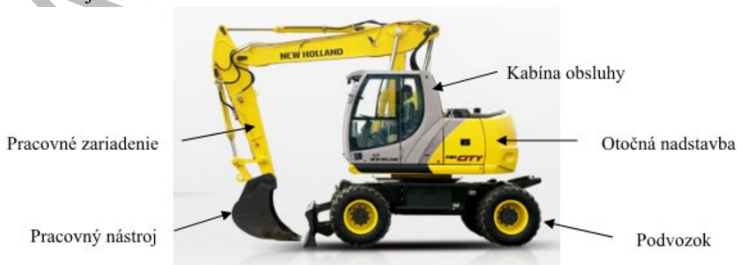
Obr. 5.116 Základné moduly hydraulického rýpadla [9]
