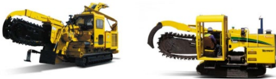
Obr. 5.195 Jednouúčelové reťazové ryhovače [9]
