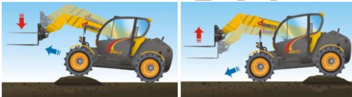
Obr. 5.86 Jazda teleskopického manipulátora so stabilizátorom polohy výložníka [9]
