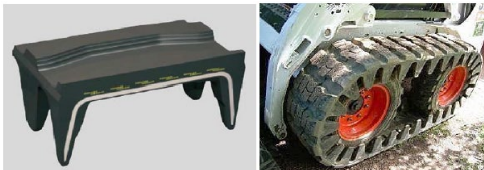
Obr. 4.61 Gumové OTT pásy – rez OTT pásom a OTT pás namontovaný na podvozku [4]
