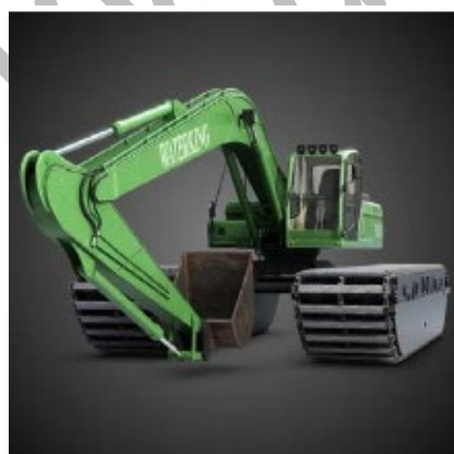
c) rýpadlo na plávajúcom podvozku
