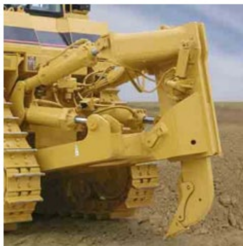
Obr. 5.27 Štvorbodový záves a príklady aplikácie na stroji [9]
