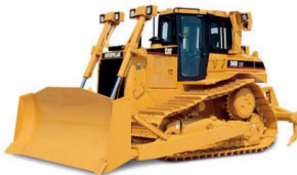
Obr. 5.8 Dozér s pásovým podvozkom Delta (1+2) [9]
