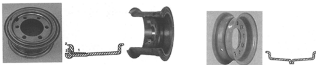
Obr. 3.25 Trojdielne a dvojdielne diskové koleso [3]
