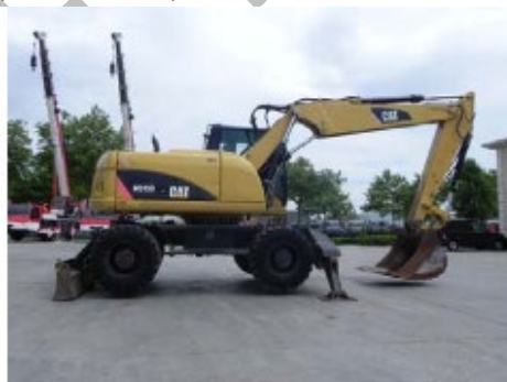
b) kolesové rýpadlo s deleným výložníkom
