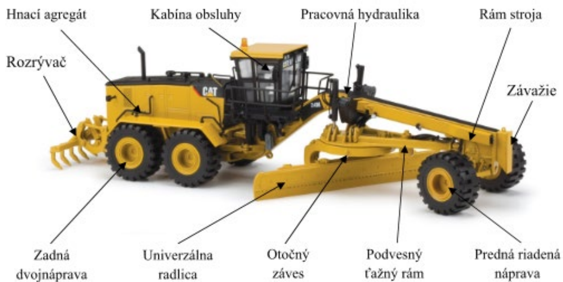
Obr. 5.39 Základné časti motorového grejdra [9]
