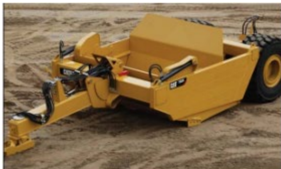
Obr. 5.163 Jednoosí vlečný skrejper [9]
