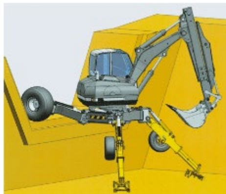
Obr. 5.122 Prekonávanie prekážok kráčajúcim rýpadlom [9]
