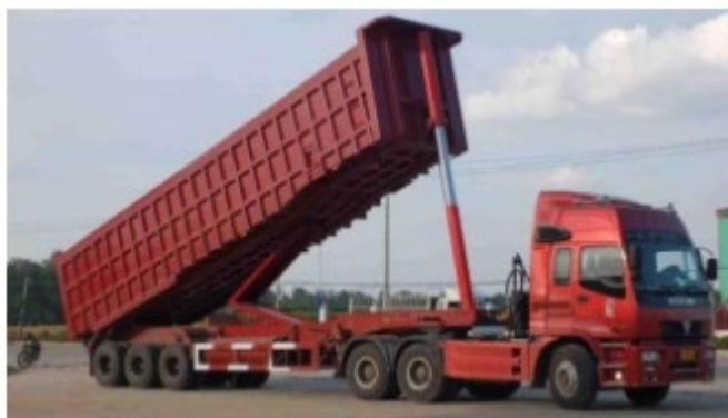
Obr. 5.228 Návesný damper s dlhou korbou [9]
