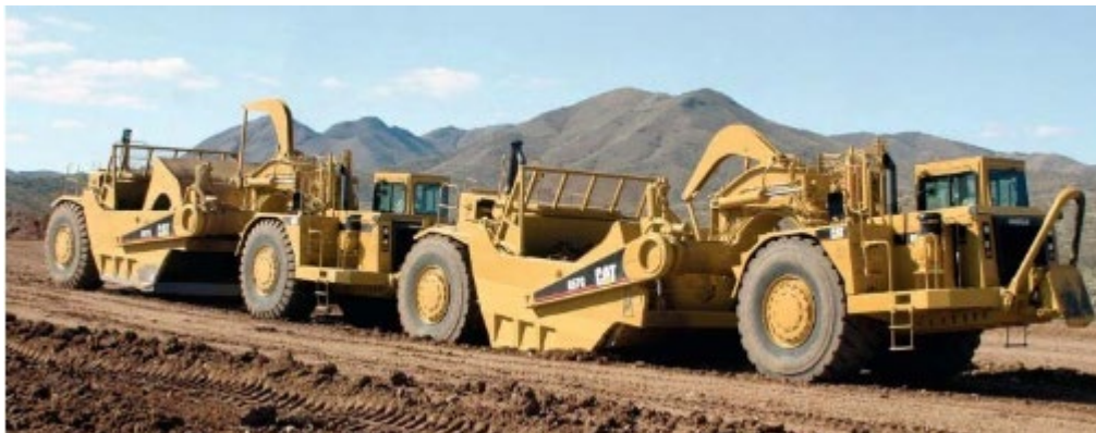
Obr. 5.173 Zostava skrejprov v režime „push-pull“ [9]
