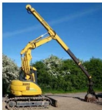
d) rýpadlo určené na hĺbenie studní
