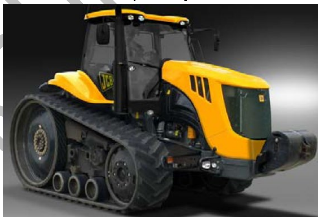
Obr. 4.21 Dvoj pásový podvozok integrovaný do zostavy ťahača [9]
