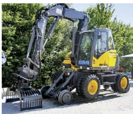
c) dvojcestné komunálne rýpadlo na železničnom podvozku
