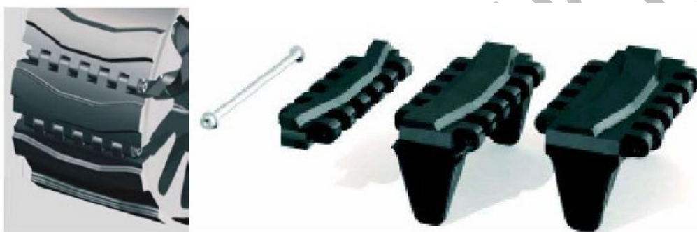
Obr. 4.62 Spojovacie články OTT pásu rôznej dĺžky [4]
