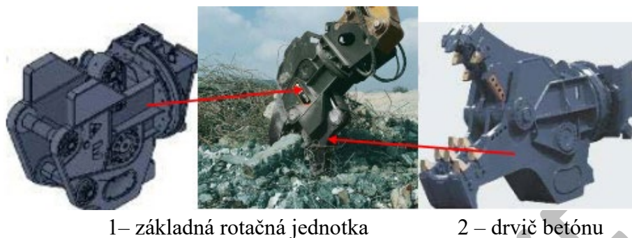
Obr. 5.147 Základné časti pracovného nástroja na rozpojovanie stavebných ruín [9]
