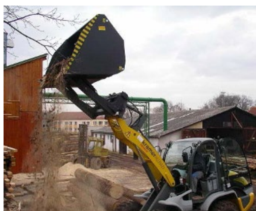
b) Lopata s vysokým naklápaním
