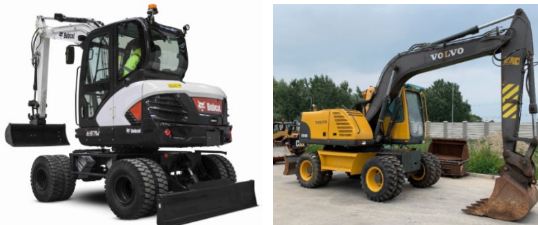
Obr. 3.15 Podvozky s vlastným pohonom riadené z otočnej nadstavby [9]
