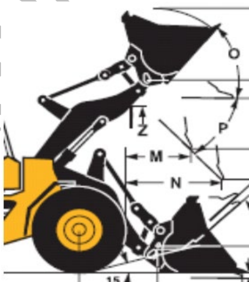
Obr. 5.79 Pracovné zariadenie nakladača s TP –kinematikou [9]
