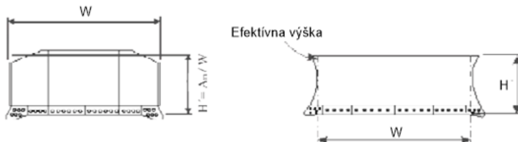
Obr. 5.19 Efektívna výška radlice H' [8]
