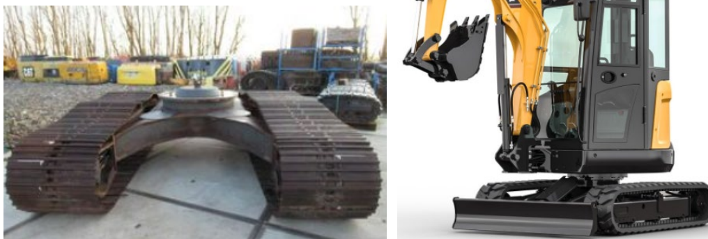
Obr. 4.22 Kompaktné dvoj pásové podvozky ako nosiče otočných nadstavieb [9]
