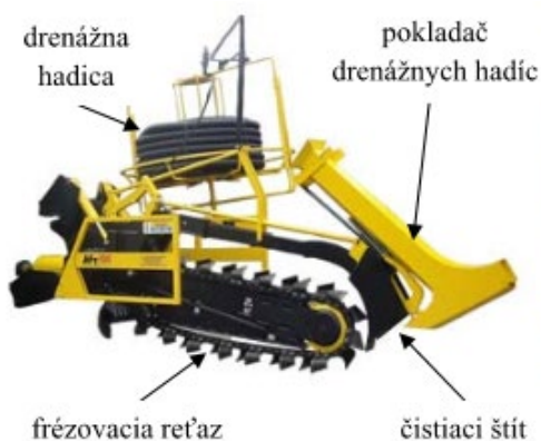
Obr. 5.199 Drenážny ryhovač AFT 100 [9]
