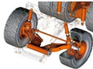
Obr. 5.217 Zavesenie predných riadených kolies na vlečných ramenách (Hitachi) [9]
