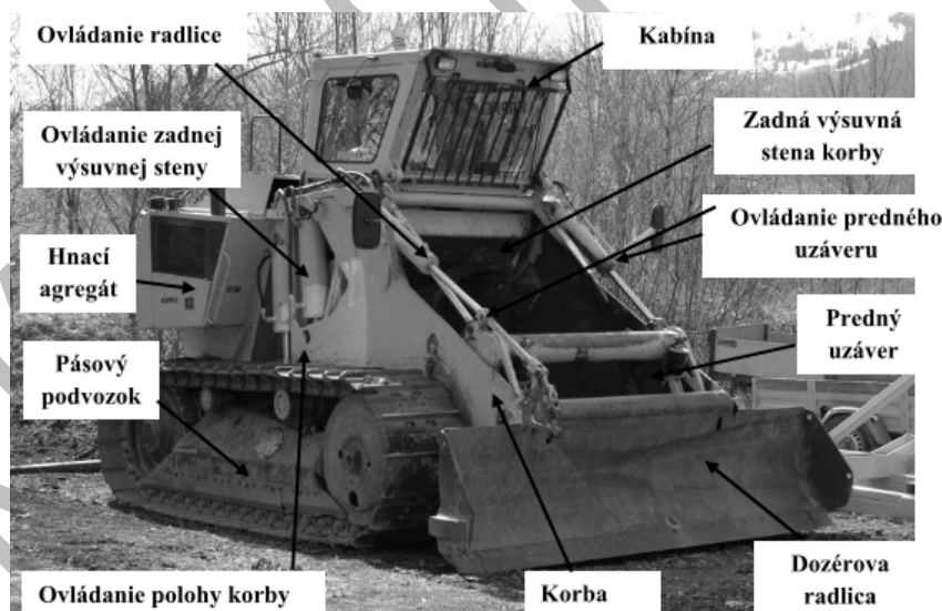
Obr. 5.175 Základné moduly skrejper-dozéra [9]
