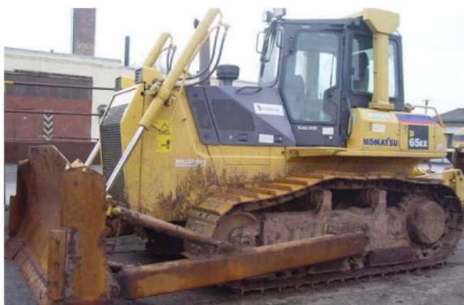
Obr. 5.13 Ovládanie radlice hydraulicky [7]
