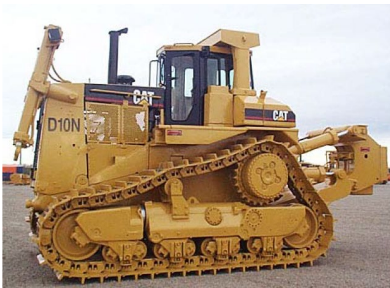
Obr. 4.18 Príklad uloženia pojazdových kladiek na vahadlách odpružených gumovými pružinami [5]
