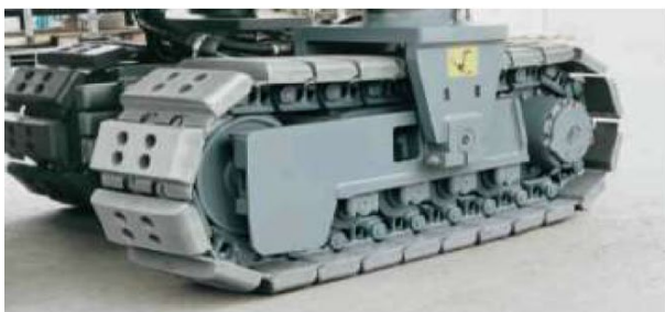
Obr. 4.15 Podvozky s pevne uloženými pojazdvými kladkami [5]
