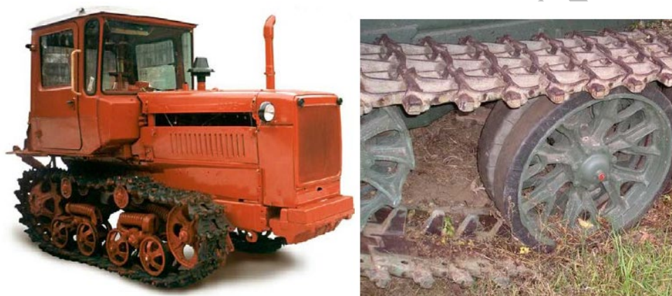
Obr. 4.41 Konštrukcia článkových pojazďových pásov [4]
