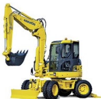
a) pracovné zariadenie na otočnom kozlíku
