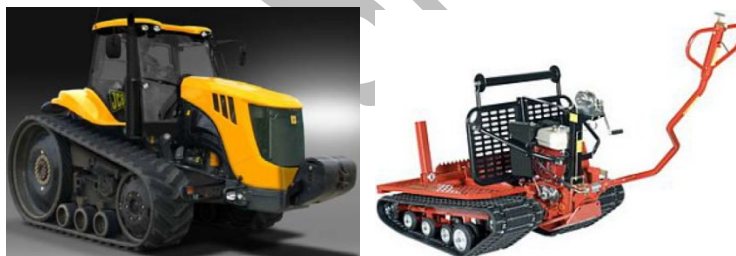
Obr. 4.14 Použitie pásových podvozkov na poľnohospodárskych a lesníckych strojoch [5]
