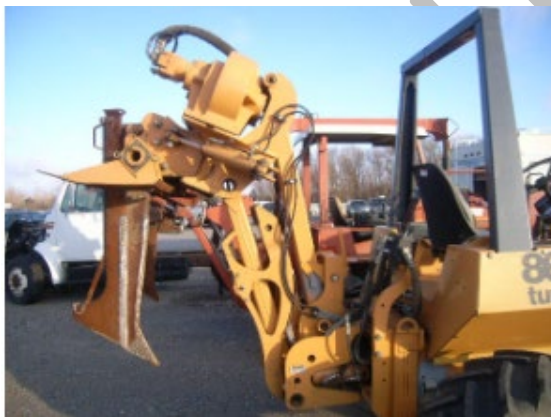
Obr. 5.196 Ryhovač s vibračným vertikálnym nožom [9]
