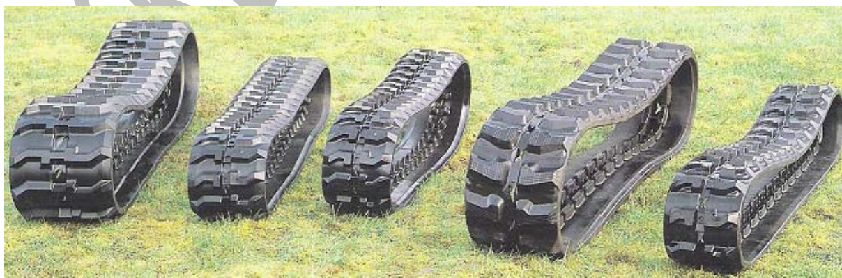
Obr. 4.58 Prehľad dezénov ponúkaných výrobcami gumových pásov [4]
