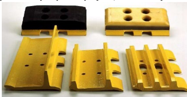
Obr. 4.49 Typy oporných dosiek pásov, 1-, 2-, 3-rebrové, s gumovými pätkami, z nešpiniacej gumy [4]
