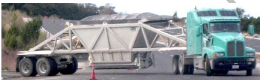
Obr. 5.229 Návesný damper s kónickou korbou s výklopným dnom [9]
