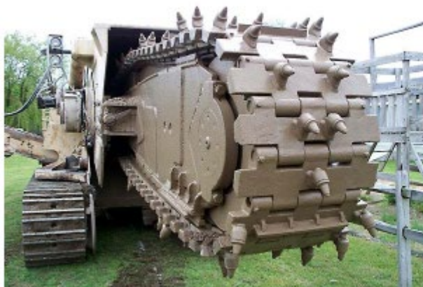
Obr. 5.201 Detail frézovacieho pásu TESMEC M5 [9]
