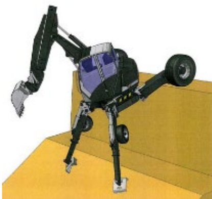
Obr. 5.122 Prekonávanie prekážok kráčajúcim rýpadlom [9]
