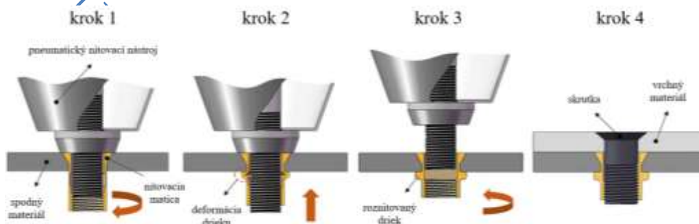
Obr. 3.30 Proces montáže nitovacej matice [46, 48]
