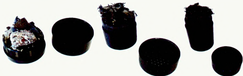
Obr. 5.19 Sypaný recyklovaný textil v troch hrúbkach
