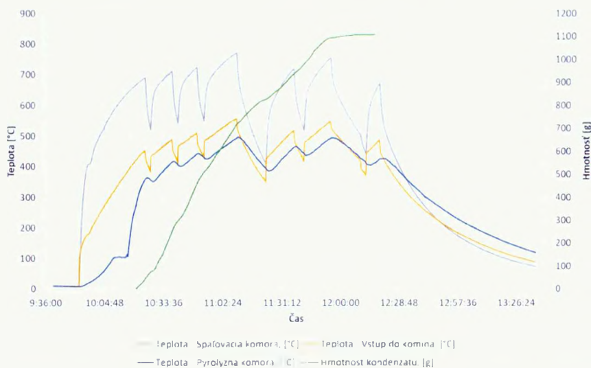
Obr. 7.9 Priebeh teplôt a hmotnosti kondenzátu z vybraného cyklu pyrolýzneho spracovania plastového odpadu
