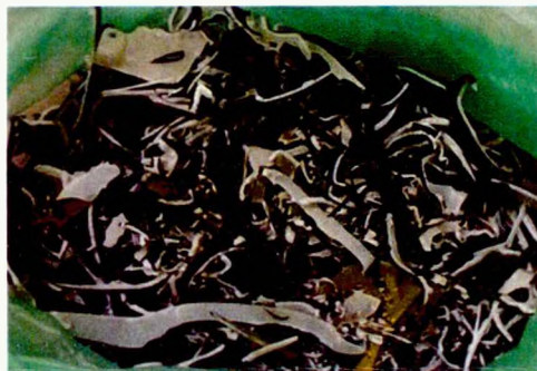
Obr. 7.2 Vytvorená pracovná zmes plastového odpadu, a) zmes podvrveného automobilového odpadu, b) zmes podvrvených PET obalov
