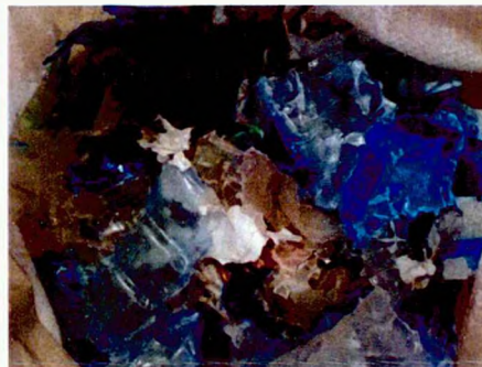
Obr. 7.2 Vytvorená pracovná zmes plastového odpadu, a) zmes podvrveného automobilového odpadu, b) zmes podvrvených PET obalov
