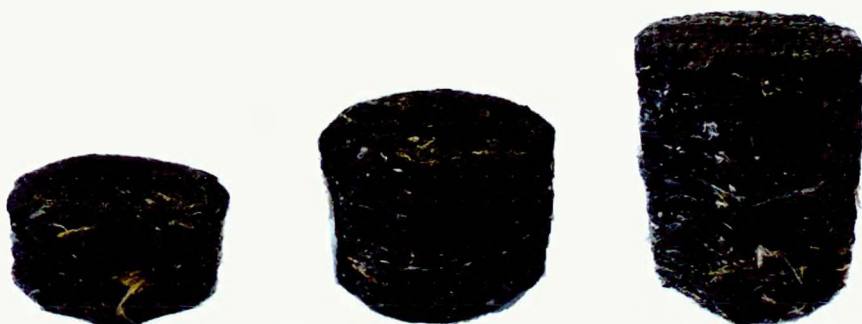
Obr. 5.29 Kompaktný materiál z recyklovaného textilu v troch hrúbkach
