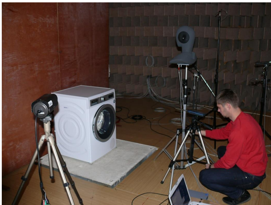
Obr. Meranie psychoakustických parametrov automatických práčok
