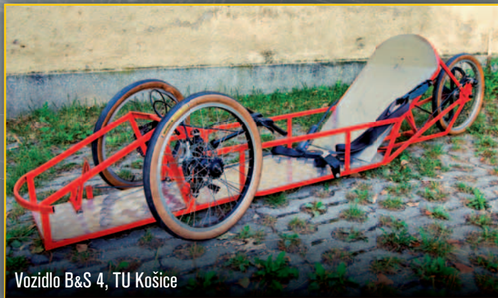
Vozidlo B&S 4, náhon vozidla s motorom Honda GX 25
