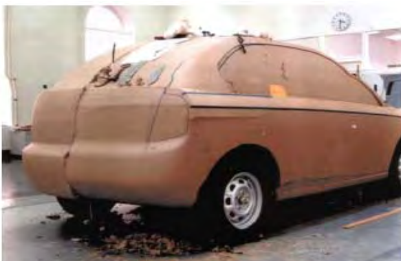
Obr. 5.5: Hlinený model automobilu
