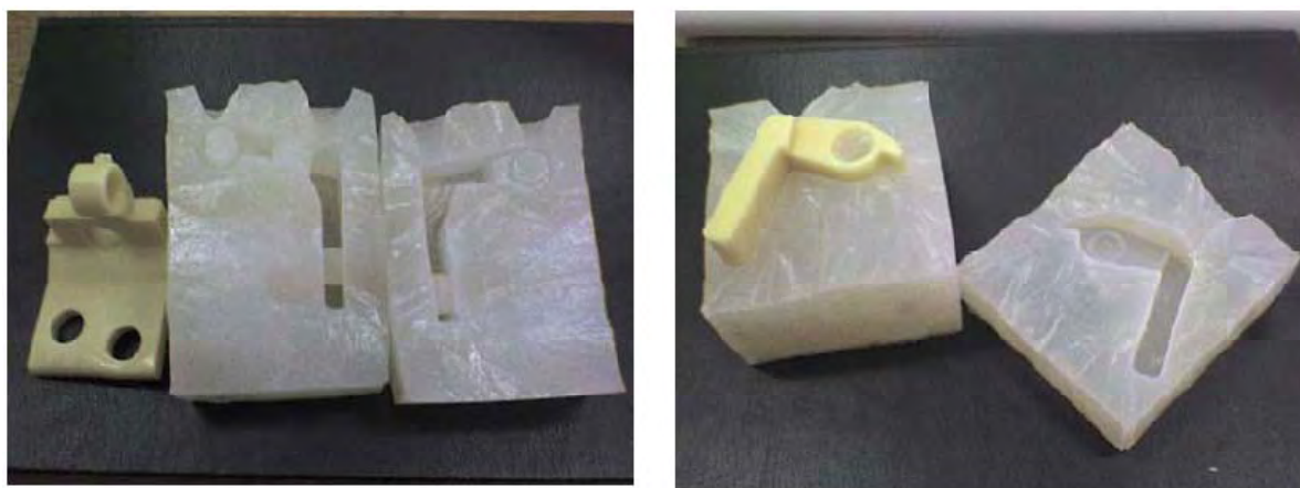
Obr. 5.9: Silikónové formy s PUR odliatkami
