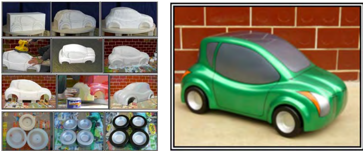
Obr. 5.7: Výroba modelu automobilu
