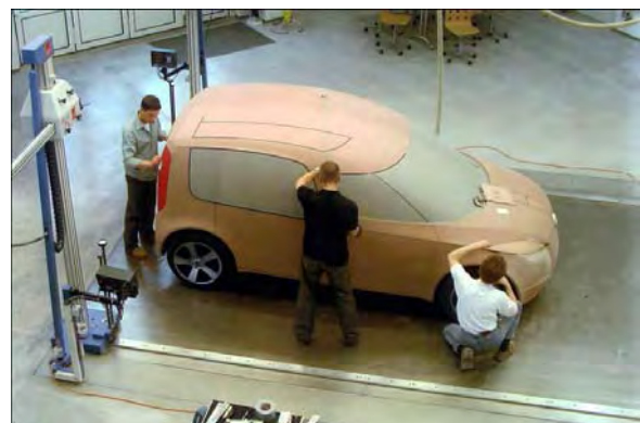
Obr. 5.5: Hlinený model automobilu
