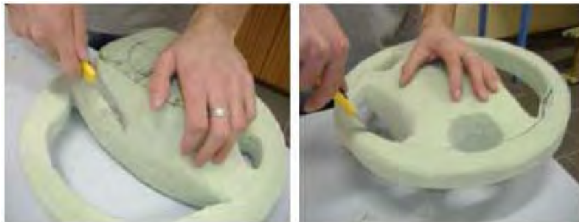
Obr. 5.6: Výroba modelu volantu z polystyrénovej peny
