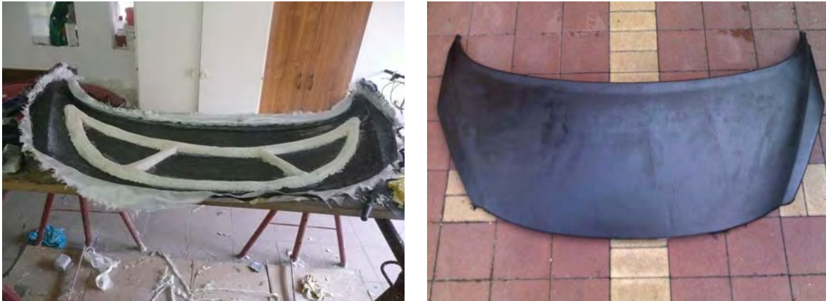
Obr. 5.8: Výroba a hotový laminovaný diel z uhlíkového kompozitu
