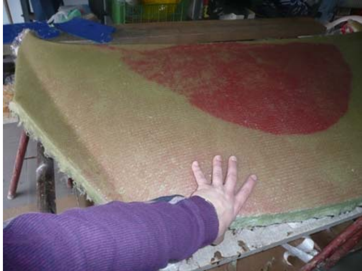
Obr. 6: Oddel'ovanie formy od kapoty
