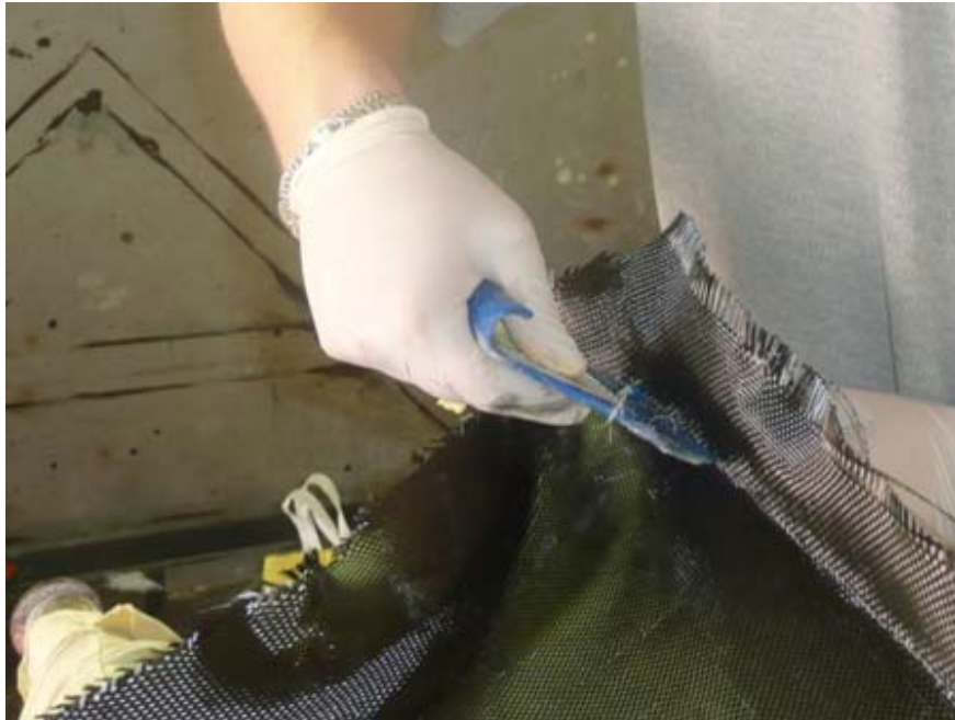
Obr. 9: Vkladanie uhlíkových vlákien do formy
