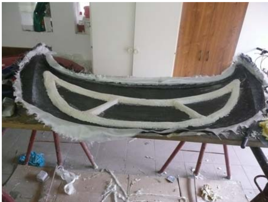
Obr. 10: Spevnenie kapoty pomocou PUR peny
