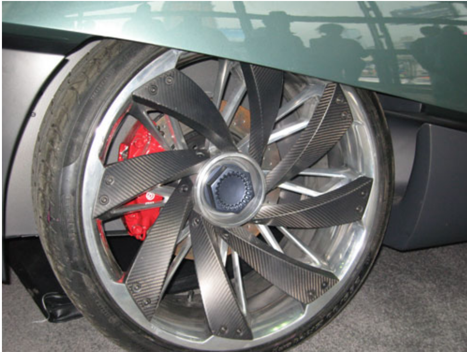
Obr. 11: Kombinácia uhlíkových vlákien a hliníka využitá pri diskoch kolies.
