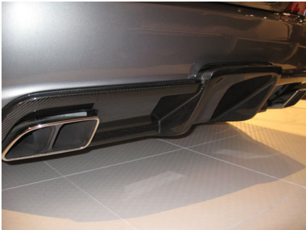
Obr. 12: Zadný spodný difúzor z uhlíkových vlákien.
