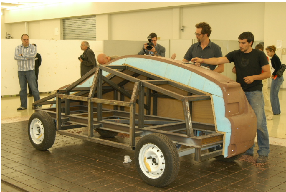
Obr. 4: Nosný rám hlineného modelu
