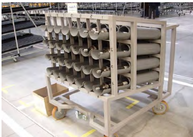
Obr. 6 Prepravná zásobovacia plošina s kačušovým zásobníkom [1]
