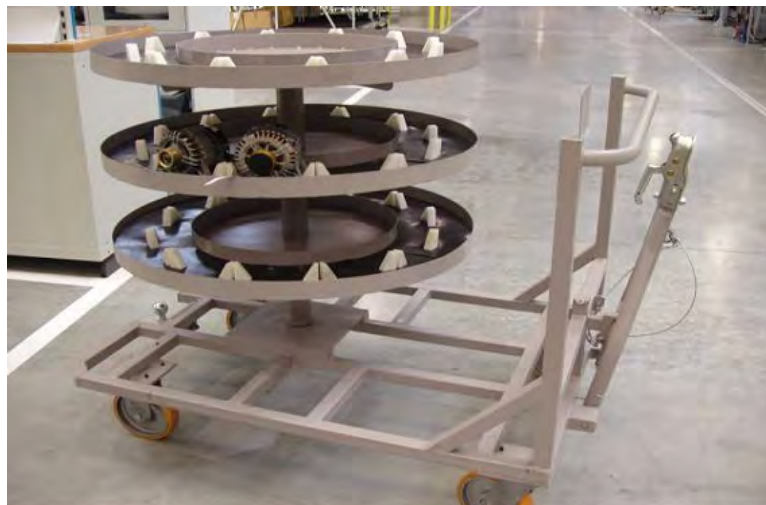
Obr. 5 Prepravná zásobovacia plošina s rotačným zásobníkom [1]
