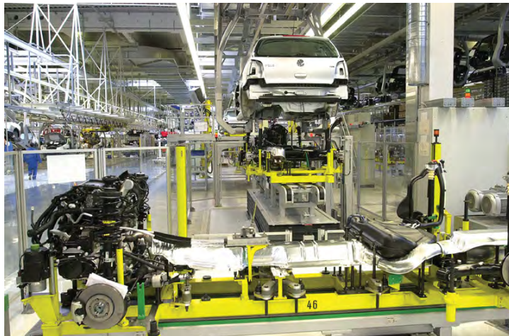
Obr. 11 Zariadenie na prenos náprav a motora [3]
