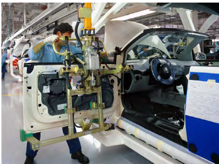
Obr. 14 Zariadenie pre montáž modulu dverí na automobil [2]
