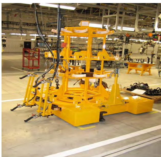
Obr.8 Prepravná manipulačná zásobovacia plošina [1]
