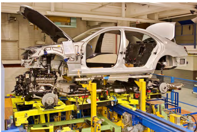
Obr. 15 Zariadenie pre kompletizáciu podvozku a karosérie [4]
