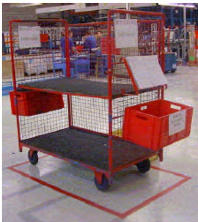
Obr. 5: Príklad červenej nádoby na nesprávne súčiastky
