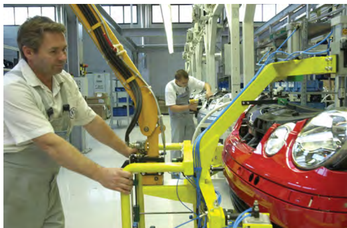
Obr. 12 Zariadenie pre uvedenie na montáž predného panelu automobilu [3]
