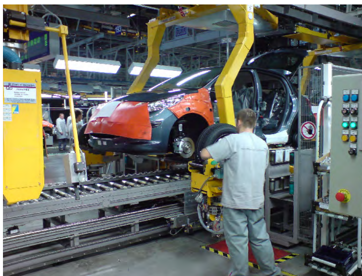
Obr. 3: Pomocný montážny prvok určený pre nasadenie kolesa na automobil [1]
