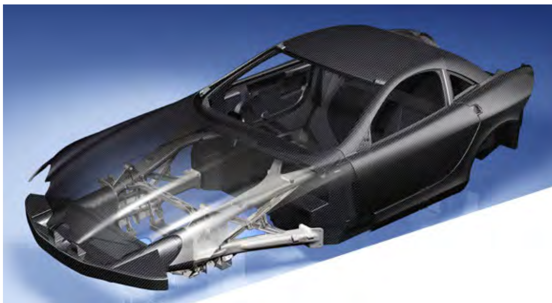
Obr. 6: Mercedes SLR z uhlíkovou karosériou
