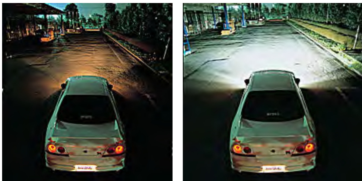
Obr. 6: Porovnanie halogénových žiaroviek (vľavo) a xenónov (vpravo)
