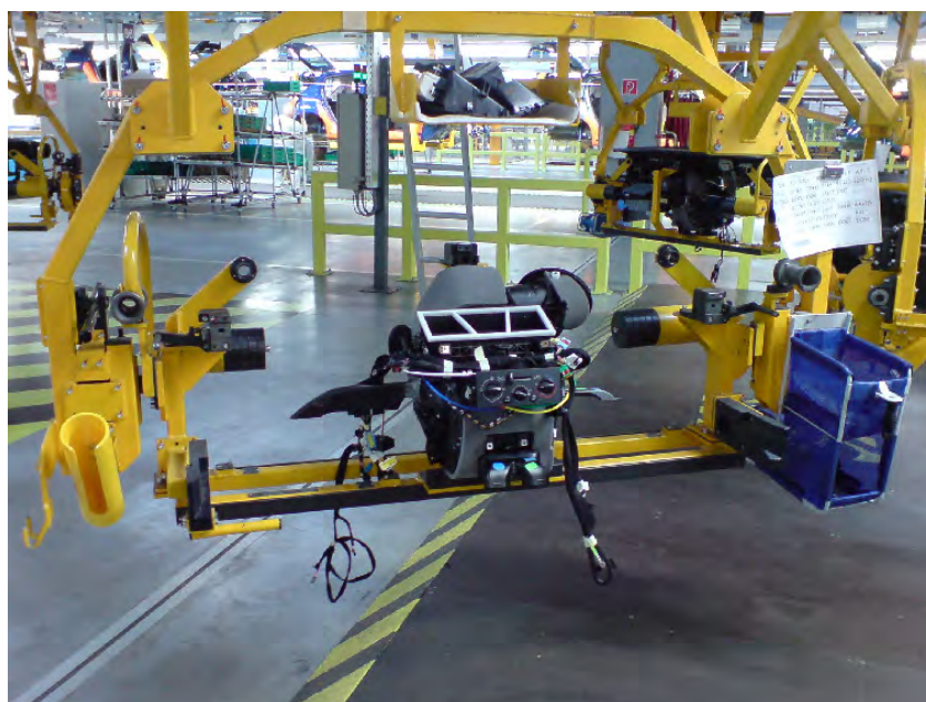
Obr. 2: Pomocný prepravný rám pre montáž kúrenia a prístrojovej dosky
