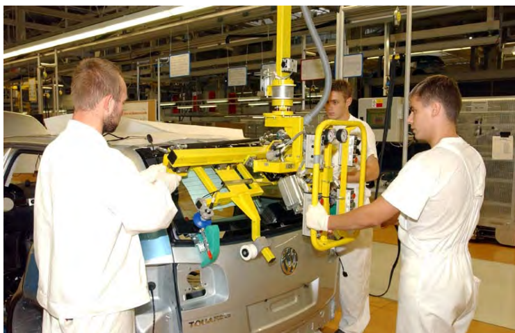
Obr. 13 Prípravok pre upevnenie zadného skla [2]
