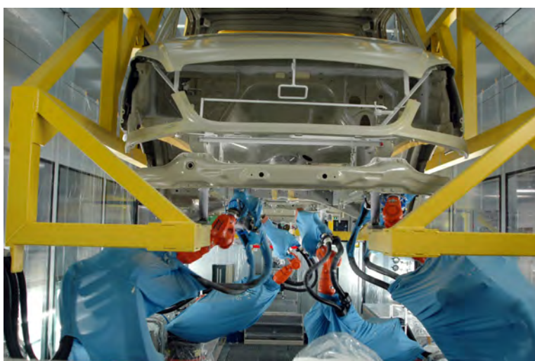
Obr. 16 Pomocné zariadenie pre lakovanie karosérie [4]
