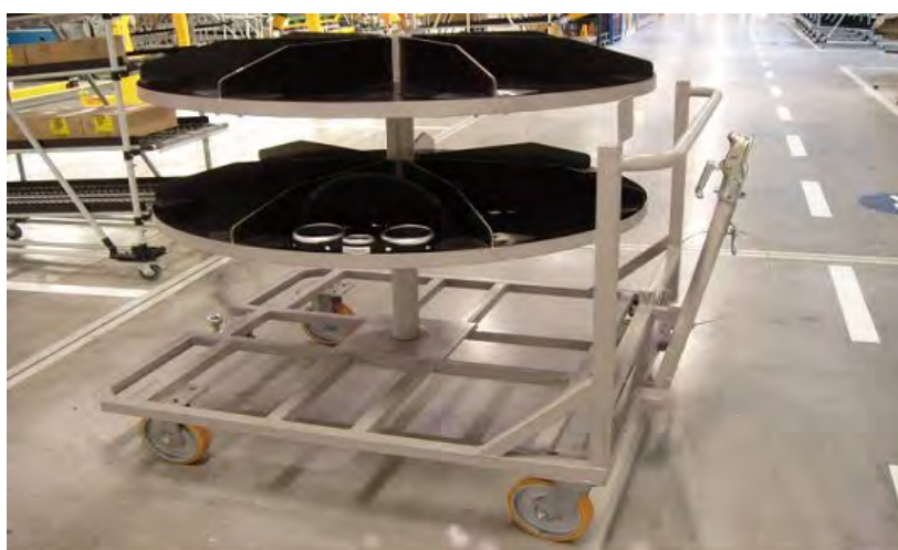
Obr. 10 Prepravná zásobovacia plošina s rotačným zásobníkom – univerzálna [1]
