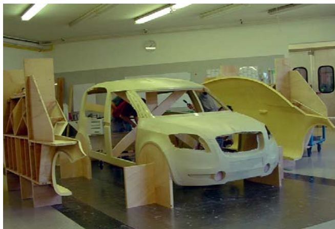
Obr. 6 Výroba karosérie prototypu automobilu z laminátu
