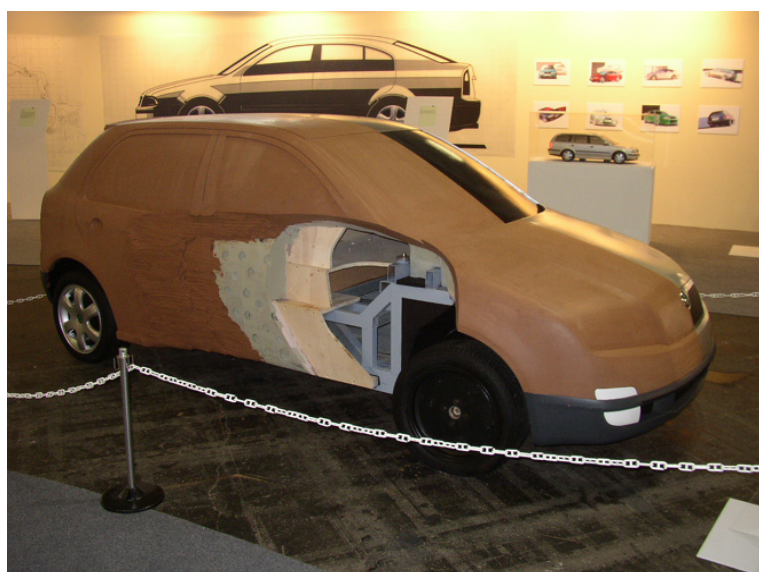
Obr. 2 Prierez hlineným prototypom a detail jeho nosnej konštrukcie [1]
