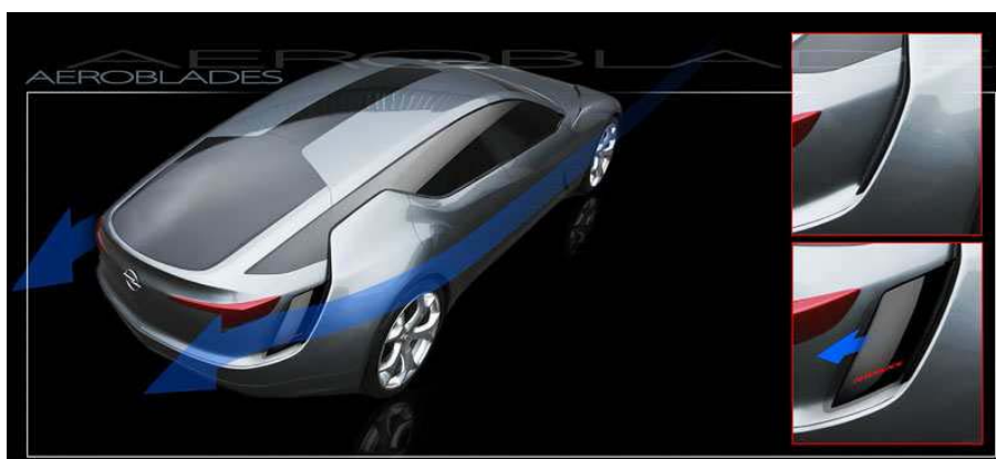
Obr. 7 Premennivé obtekanie zadnej časti s výsuvnými spojlermi Aeroblades
