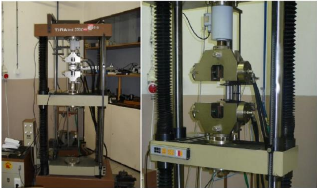
Obr. 7.12 Hydraulický trhací stroj TIRA-test 2300
