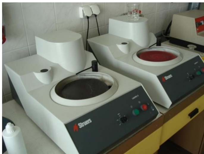
Obr. 3.5 Stroj na mechanické leštenie
