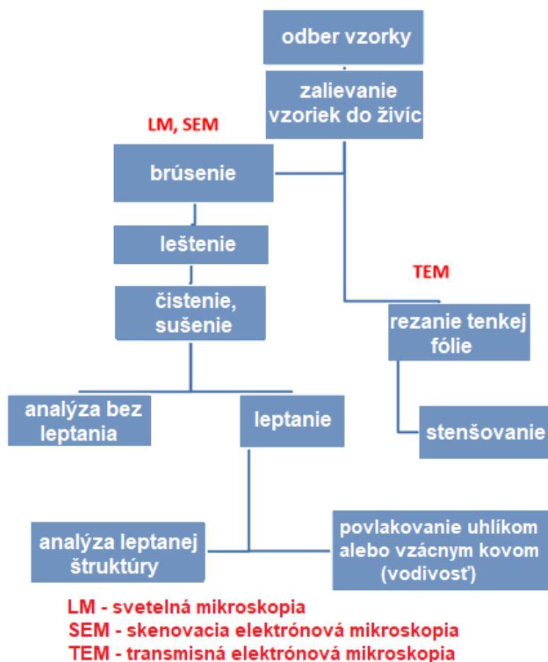
Obr. 3.1 Postup prípravy vzoriek na metalografické štúdium
