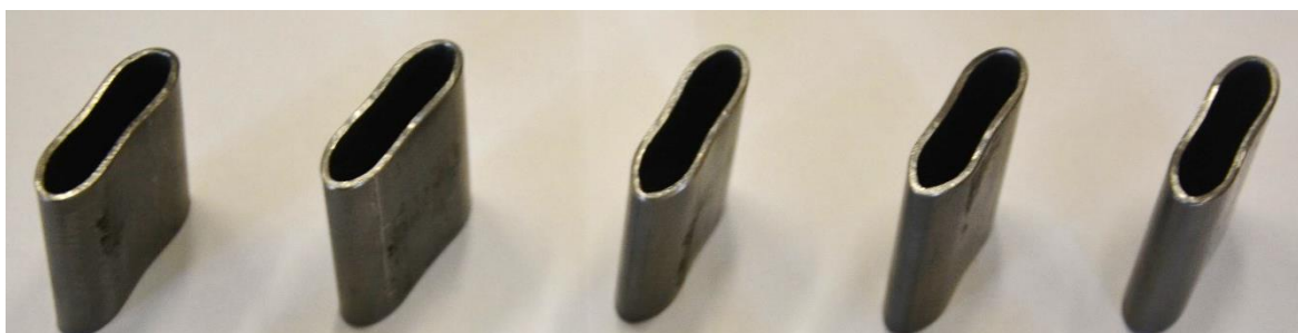
Obr. 12.22 Tenkostenné rúrky po stlačení na predpísanú hodnotu
