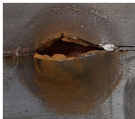
Obr. 12.11 Vzorka laserom zváraných plechov po skúške hĺbením, nevyhovujúca pre hlboké ťahanie
