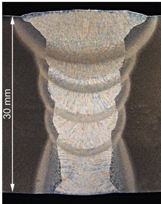
Obr. 3.19 Makroštruktúra zvaru - základný materiál, tepelne ovplyvnená zóna a zvarový kov, chyby zvaru
