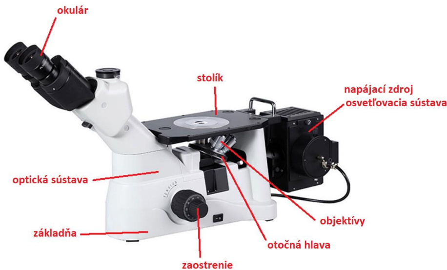
Obr. 4.6 Invertovaný (obrátený) optický mikroskop
