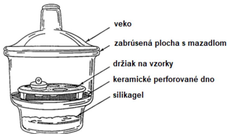
Obr. 3.11 Exikátor na uskladnenie vzoriek
