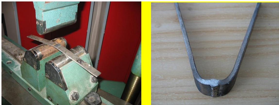
Obr. 12.7 Skúšobná vzorka tupého zvaru pred skúškou ohybom
