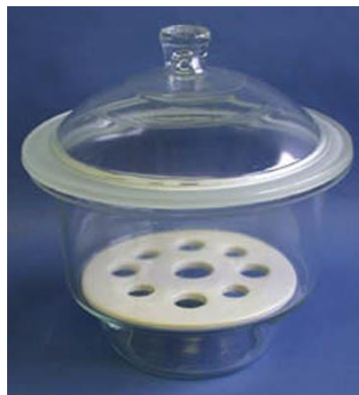
Obr. 3.11 Exikátor na uskladnenie vzoriek
