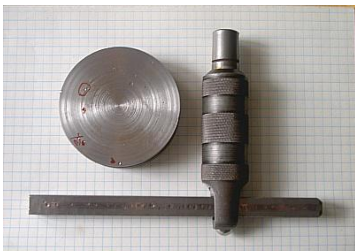
Obr. 10.5 Poldi kladivko (1 – úderník, 2 – referenčná tyč, 3 – meraný materiál)
